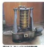
骨材ふるい分け試験機
